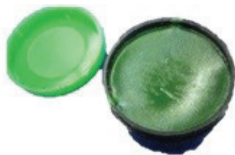
Рис. 1.10.8. Паста ГОІ використовується для доведення металевих, скляних і пластикових поверхонь
