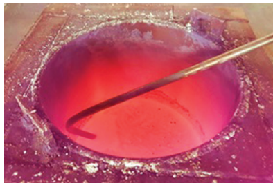
Рис. 4.8.15. Загартування з нагріванням в соляній печі-ванні
