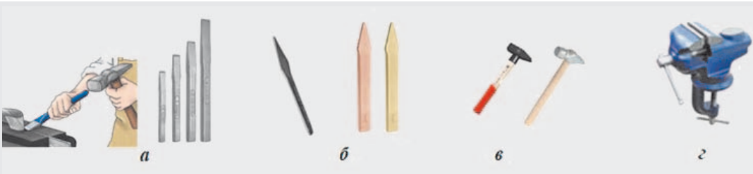
Рис. 1.2.1. Рубання металу та слюсарні інструменти, що застосовують під час рубання: а — зубило; б — крейцмейсель; в — слюсарні молотки; г — стулові лещата
