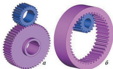
Рис. 2.2.4. Різновид зубчастих передач: а — зовнішнього зачеплення; б — внутрішнього зачеплення
