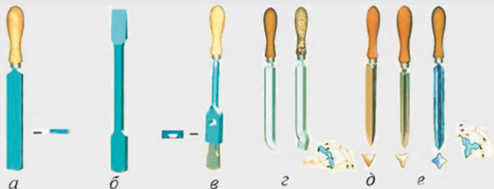
Рис. 1.10.11. Шабери: а — плоский; б — однобічний; в — двосторонній удосконалений; г — з відігнутим кінцем; д — плоский двобічний; е — три- і чотиригранні
