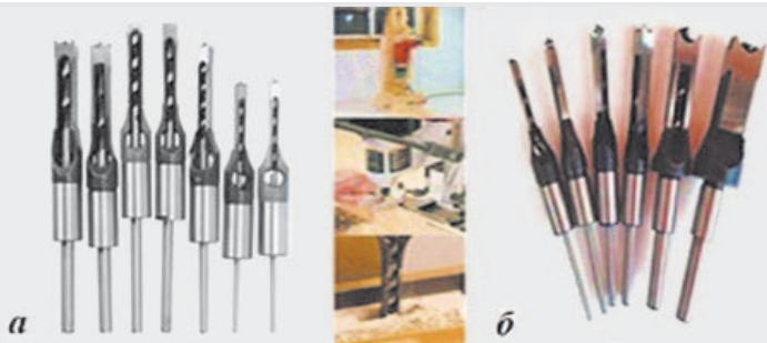
Рис. 5.4.1. Свердла для квадратних отворів (а), свердло-долото (б)
