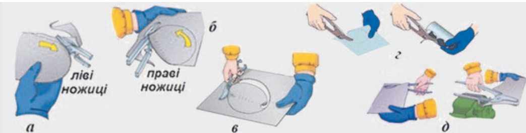
Рис. 1.4.2. Прийоми розрізання металу ручними ножицями: а — розрізання металу лівими ножицями, б — розрізання металу правими ножицями, в, е — вирізання отвору по розмічальних рисках; д — різання листової заготовки на вузькі смуги
