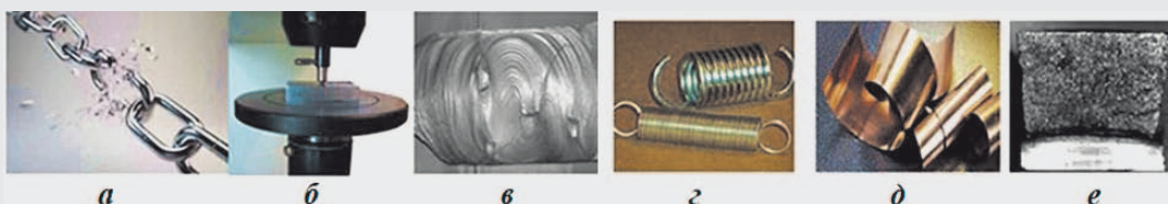
Рис. 4.3.1. Механічні властивості: а — міцність; б — твердість; в — в'язкість; г — пружність; д — пластичність; е — крихкість
