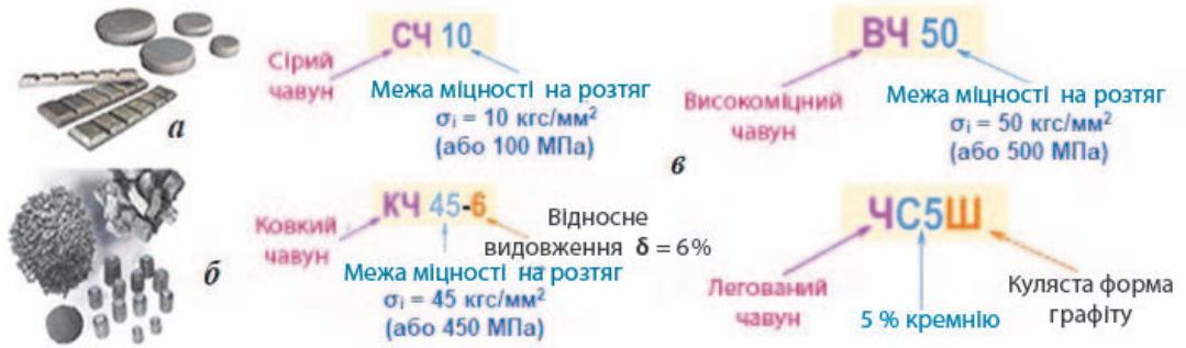
Рис. 4.2.2. Різновид чавуну: а — білий; б — сірий; в — приклад маркування чавунів
