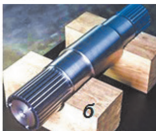
Рис. 2.2.26. Вали за швидкістю обертання: а — швидкохідний; б — тихохідний
