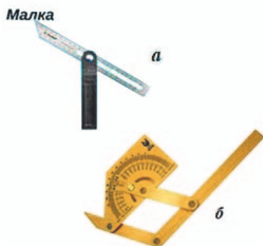
Рис. 3.5.7. Малки: а — проста; б — подвійна
