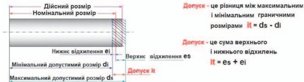
Рис. 3.2.3. Розміри деталі, відхилення та допуск
