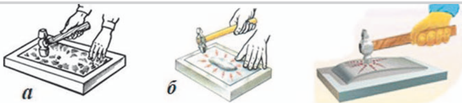
Рис. 1.3.2. Виправлення листової сталі молотком (а) і схема здійснення ударів для виправлення опуклості, розташованої всередині листа (б) і з хвилястістю по краях (в)
