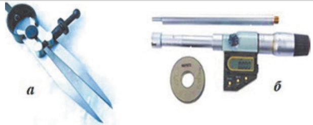
Рис. 3.5.3. Вимірювальний інструмент: а — кронциркуль; б — нутромір
