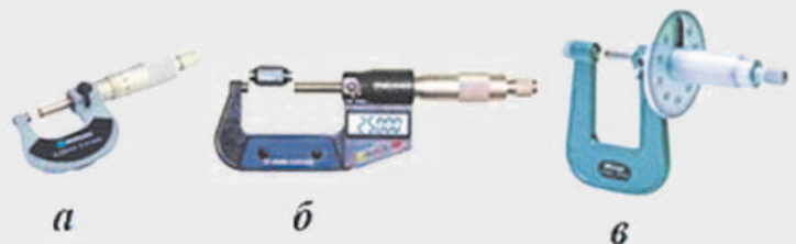
Рис. 3.5.11. Мікрометри: а; б — МК (гладкі) — для вимірювання зовнішніх розмірів; в — МЛ (листові з циферблатом) — для вимірювання товщини листів і стрічок; г — МЗ (зубомірні) — для вимірювання зубчастих коліс
