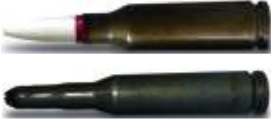
Іл. 22.19. 5,45-міліметровий патрон холостий. Використовують для імітації стрільби з автоматів АК-74 під час навчання, а також для здійснення салютів. Маса патрона — 6,6 г; порожнистої пластмасової кулі — 0,22–0,26 г; заряд швидко згораючого пороху масою 0,24 г
