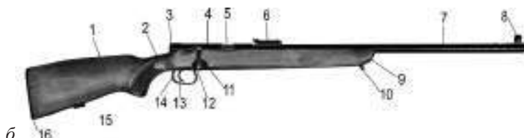
Іл. 20.1. Малокаліберна гвинтівка ТОЗ-8М, калібру 5,6 мм, з відкритим секторним прицілом: а — загальний вигляд; б — будова гвинтівки: 1 — ложе; 2 — шийка ложа; 3 — тильна кришка (ковпачок); 4 — ствольна коробка зі спусковим механізмом; 5 — вікно для заряджання і викидання стріляної гільзи; 6 — приціл; 7 — ствол; 8 — намушник; 9 — цівка ложа; 10 — верхня металева петля 11 — ручка затвора; 12 — затвор; 13 — спусковий гачок; 14 — спускова скоба; 15 — нижня металева петля; 16 — приклад
